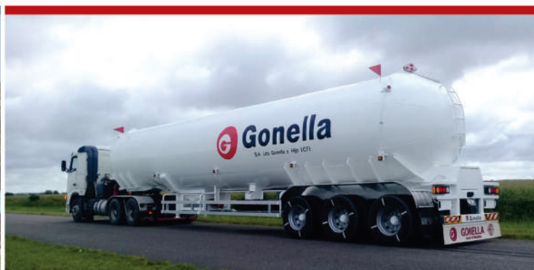
Nuevo Tanque Semirremolque para GLP Modelo 67 m 3
