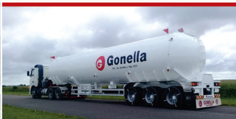
Nuevo Tanque Semirremolque para GLP Modelo 67 m 3
